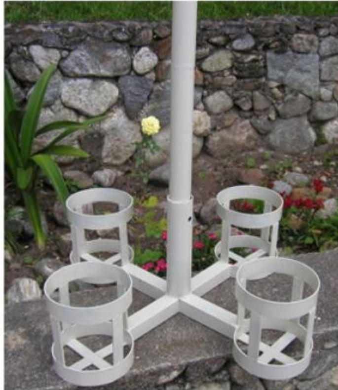
Gambar 8.5: Dasar logam ini dapat diganjal dengan karung pasir, batu, atau botol air untuk membuat panggung stabil tanpa membolongi atap
