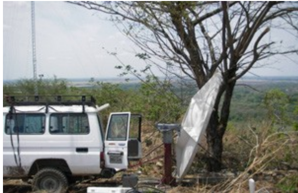
Gambar 11.34: Instalasi antenna El Baúl instalasi antena. Elevasi sebenarnya adalah 1 ° ke atas, karena antena memiliki offset 22,5 °.
