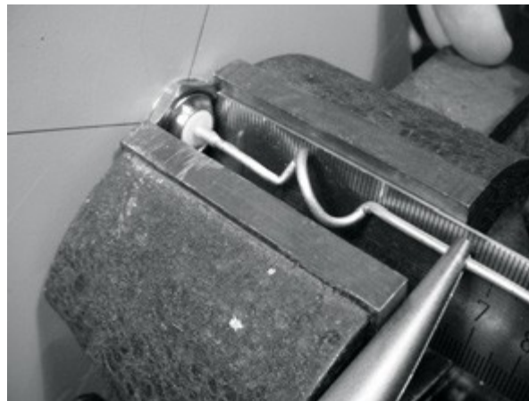
Gambar 4.27: merentangkan lilitan. Cobalah untuk secara hati-hati dan tidak untuk menggores permukaan kawat dengan tang.
