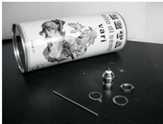
Gambar 4,33: Komponen yang diperlukan untuk membuat sebuah antena kaleng.
