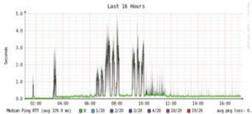
Gambar 6.28: Sebuah penyebaran tinggi jitter dibuka pada pencatatan 16 jam.
