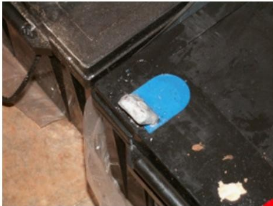
Gambar 7.2: Sebuah baterai bertimbal asam Ah 200. Terminal negatif rusak karena berat pada terminal selama transportasi.
