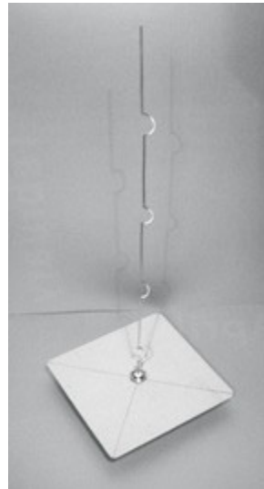
Gambar 4.29: antena yang sudah selesai berukuran 42,5 cm dari pelat hingga akhir kawat.
