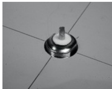
Gambar 4.22: Konektor N sebaiknya cocok dengan lubang.
