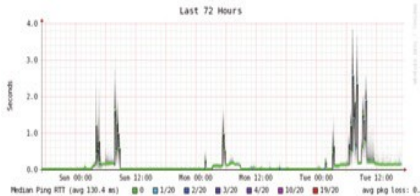
Gambar 6.29: Zoom pada catatan satu minggu menunjukkan repetisi penambahan latensi dan packet loss di pagi hari.
