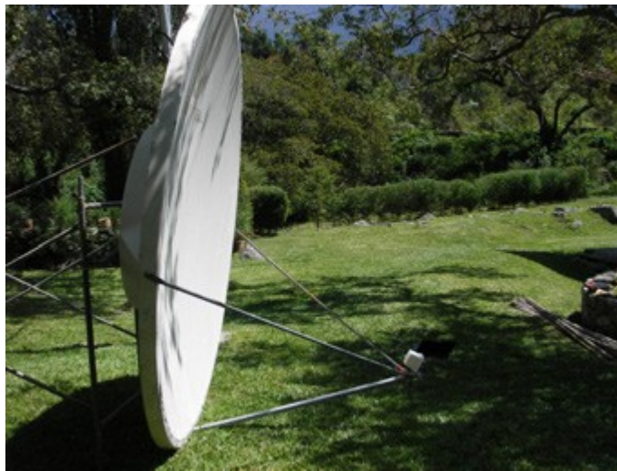
Gambar 11.29: Reflektor offset fed 2,4 m dengan antena 12 dBi di fokusnya, melihat 14 ° ke bawah. Elevasi sebenarnya adalah 8° ke atas.
