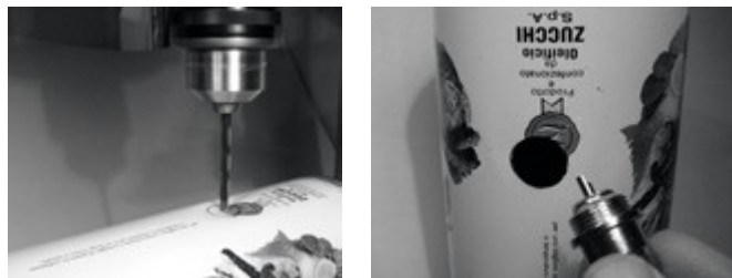
Gambar 4.36: Secara teliti borlah lubang penunjuk, kemudian gunakan mata bor yang sedikit lebih besar untuk menyelesaikan pekerjaan.
