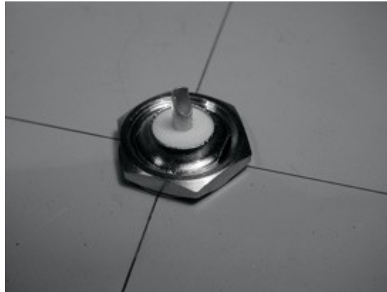
Gambar 4.24: Kencangkan konektor N ke pelat.
