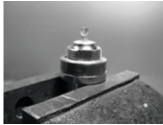
Gambar 4.23: menambahkan pipa tembaga membantu untuk mencocokkan impedansi antena agar 50 Ohm.
