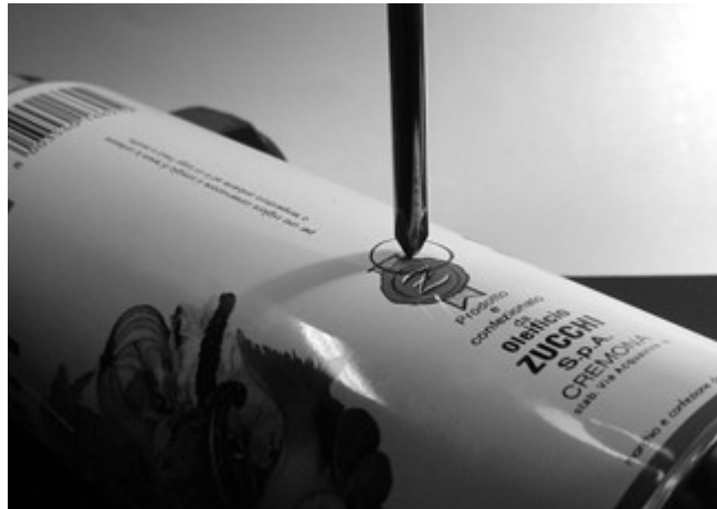
Gambar 4.35: Berikan tanda pada lubang sebelum membor.
