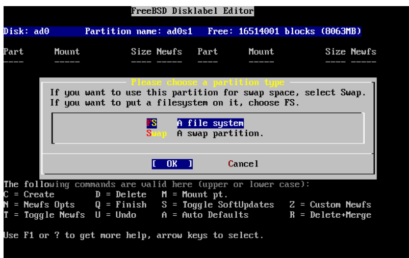
Figura 2.20. Scelta del Tipo della Partizione Root
